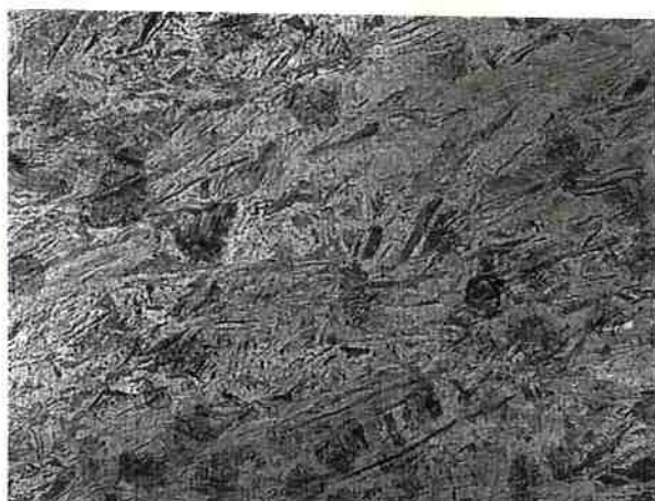
Fig. 44 - Relaminado e solubilizado por 1 hora a 820°C (100x)
