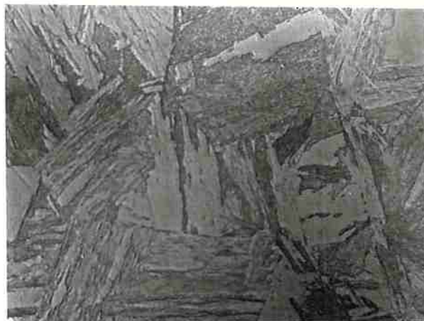
Fig. 51 - Forjado e laminado (500x)
