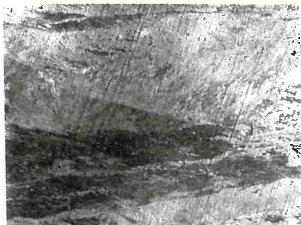
Fig. 45 - Relaminado e solubilizado por 1 hora a 820°C (500x)
