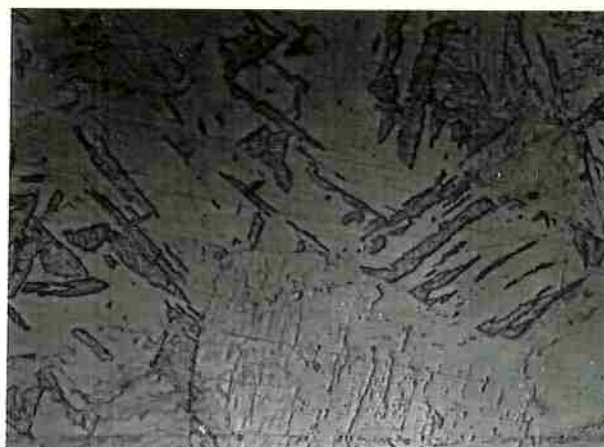
Fig. 31 - Forjado e laminado (500x)
