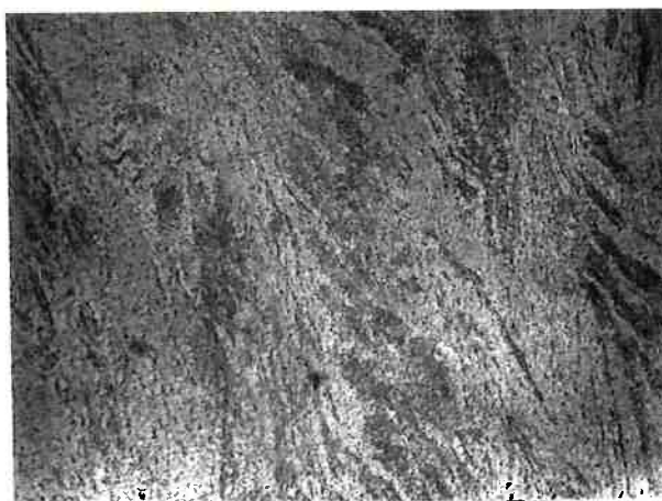
Fig. 15 - Relaminado e solubilizado por 1 hora a 820°C (500x)
