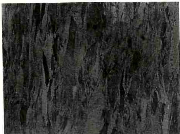
Fig. 44 - Relaminado e solubilizado por 1 hora a 820°C (100x)
