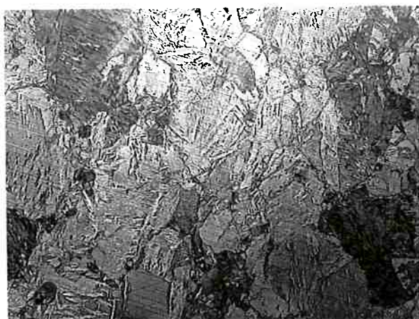
Fig. 40 - Forjado e laminado (100x)
