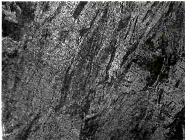
Fig. 35 - Relaminado e solubilizado por 1 hora a 820°C (500x)
