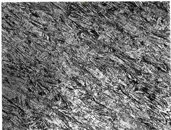
Fig. 34 - Relaminado e solubilizado por 1 hora a 820°C (100x)
